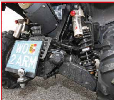
Heck: Einstellbare Stoßdämpfer & Sperr-Diff
