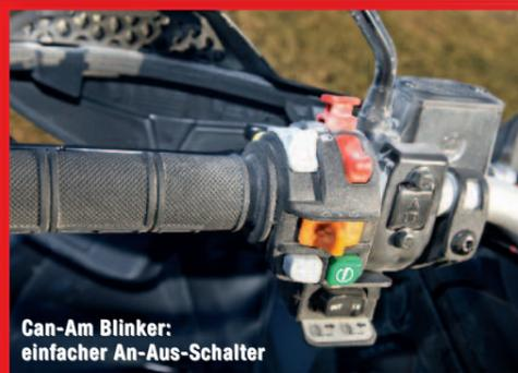
Can-Am Blinker: einfacher An-Aus-Schalter
