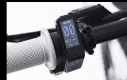
Tachometer im schlanken Design zeigt Geschwindigkeit, Batteriestand, Spannung und Kilometer an
