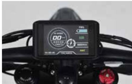
Tachometer zeigt unter anderem die Geschwindigkeit, Batteriestand, Spannung und Kilometer an
